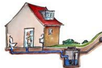
Eksempel på pumpebrønd
